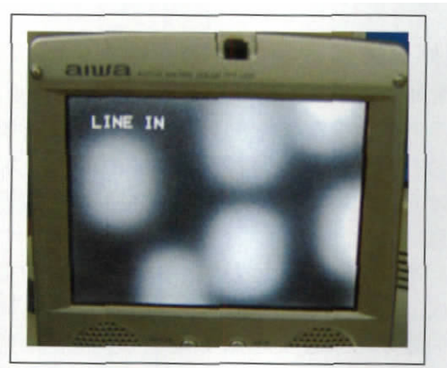
图 4 涂有水杨酸钠的 CCD 相机对针孔阵列成像
