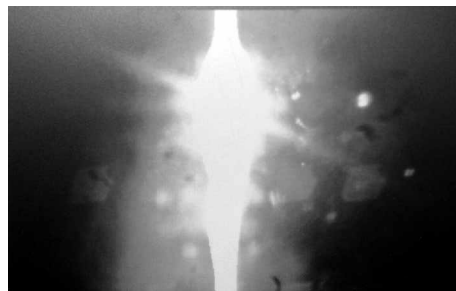
图 2 计算机采集到的 CCD 部分区域饱和时的图像
