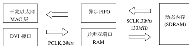
图2 发送系统高速数据缓冲原理
