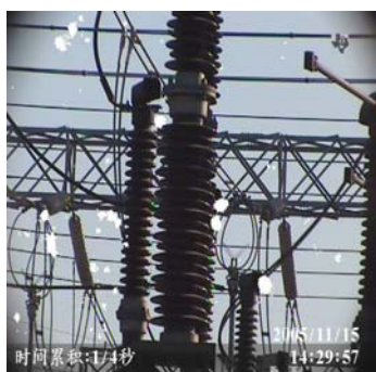
图 5(a) 电晕信号检测图
