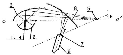
1、反射镜式光源系统，包括：光源（1）、方棒（6），其特征在于还包括：半球面反射镜（2）、半椭球面反射镜（3），将光源（1）放在半椭球面反射镜（3）内的第一焦点（4）上，在半椭球面反射镜（3）的对面放置半球面反射镜（2），使光源（1）在半椭球面反射镜（3）的第二焦点（5）上成像，方棒（6）放在半椭球面反射镜（3）的第二焦点（5）附近，让方棒（6）相对于轴线O—O'放置的倾斜角 $\alpha$ 为：
