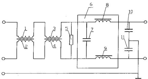
1.一种基于电磁兼容性的电源噪声滤波器，包括共模电感线圈（1）、共模电感线圈（2）、电阻（5）、共模电容（10）和（11），其特征是它还包括共模电感线圈（3）、共模电感线圈（4）、差模噪声抑制电路（6）；一端输入引线与共模电感线圈（1）、共模电感线圈（3）和差模噪声抑制电路（6）的一端输入引线顺序连接，另一端输入引线与共模电感线圈（2）、共模电感线圈（4）和差模噪声抑制电路（6）的另一端输入引线顺序连接，电阻（5）的一端与共模电感线圈（3）和差模噪声抑制电路（6）的公共接点相连，电阻（5）的另一端与共模电感线圈（4）和差模噪声抑制电路（6）的公共接点相连；共模电容（10）和（11）串联，并跨接差模噪声抑制电路（6）的两个输出引线即两个输出端之间，共模电容（10）和（11）的公共接点接地。
