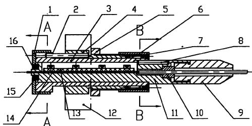
1、一种激光腔内光纤耦合定位及装夹装置；它包括钢套（1）、轴向导向键（2）、轴向移动座（3）、水平位移块（4）、轴向锁紧螺母（5）、调节螺帽（6）、压簧（7）、光纤座轴向防转动键（8）、修饰帽（9）、径向护套（10）、光纤座（11）、光学四维调节架（12）、光纤固定压板（13）、光纤（14）、磁环（15）、反射圆环（16）、螺钉（17）；其特征在于：采用压板式固紧的方式，实现了光纤在激光腔中的六维方向准确定位；
