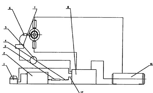
**1、 调控激光谐振腔内倍频晶体温度的装置，其特征在于该装置包括压缩机（1）、冷凝器（2）、水分子过滤器（3）、毛细管（4）、温控开关（5）、传感器（6）、示值表（7）、蒸发器（8）、晶体支撑架（9）、晶体冷却套（10）、水嘴（11）、水管（12）、水固胶（13）、晶体（14）、三维调节架（15）、磁力泵（16）、紫铜管（17）；**
