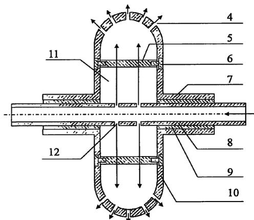
1. 一种数控抛光用非接触式轮状喷液磨头，包括驱动轴和磨头；其特征在于还包括内支撑杆(5)及固定螺丝(6)、抛光液供给管(8)、磨头空腔(11)、抛光液出孔(12)；空心驱动轴(7)垂直于空心轮状磨头(10)，两者为一体件或者是组合件；轮的边缘的截面形状可以是弧线或直线；空心驱动轴(7)套装在抛光液供给管(8)上，两者之间通过磁流体(9)密封层连接；供给管抛光液出口(12)与磨头空腔(11)相通；空心轮状磨头(10)的两个侧壁与空心驱动轴(7)垂直，在空心轮状磨头(10)的磨头空腔(11)内，以抛光液供给管(8)为对称轴的两个侧壁上均匀装有内支撑杆(5)支撑；通过固定螺丝(6)将空心轮状磨头(10)的两个侧壁与内支撑杆(5)固连；在空心轮状磨头(10)的工作面上开有抛光液喷出孔(4)；抛光液喷出孔(4)的大小和分布可以是规则的，也可以是不规则的。
