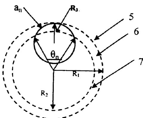
1、一种用于高功率光纤激光器的双包层光纤，包括：纤芯（1）、内包层（2）、边界（3）、外包层（4），其特征在于：在内包层（2）本体的外边缘形成边界（3），边界（3）由多个圆弧 $a_n$ 组成，每个圆弧 $a_n$ 的半径 $R_3$ 各不相同，圆弧 $a_n$ 呈现非对称分布。
