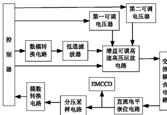
1. 一种高压运放实现 EMCCD 信号驱动的系统,该系统包括控制器、数模转换电路、低通滤波器、增益可调高速高压运放电路、第一可调电压器、第二可调电压器、交流耦合电路、直流电平嵌位电路、分压采样电路和模数转换电路;其特征是,所述控制器的输出端分别与数模转换电路的输入端、第一可调电压器的输入端、第二可调电压器的输入端和增益可调高速高压运放电路的输入端连接,所述控制器向数模转换电路输出方波的幅度参数信号,控制器向第一可调电压器、第二可调电压器和增益可调高速高压运放电路输出对应的数字参数值;
