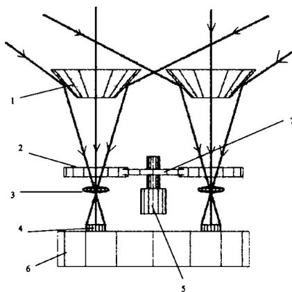
1. 一种滤光片式双波段小型紫外全向成像仪系统,其特征在于,包括两个紫外宽波段成像仪、窄带滤光片(2)、滤光片轮(7)和步进电机(5),所说的紫外宽波段成像仪包括N棱锥反射镜(1)、宽波段紫外透镜组(3)、CCD探测器(4)和电子学系统(6),N棱锥反射镜(1)前面依次放置宽波段紫外透镜组(3)、CCD探测器(4)和电子学系统(6),CCD探测器(4)与电子学系统(6)相连,窄带滤光片(2)放置在宽波段紫外透镜组(3)和N棱锥反射镜(1)之间,步进电机(5)放置在两个紫外宽波段成像仪之间,滤光片轮(7)装在步进电机(5)上,窄带滤光片(2)装在滤光片轮(7)上。
