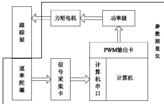
1. 基于速度计的光电跟踪系统跟踪架参数测试仪，包括速度计和计算机，其特征在于，该装置还包括可调功率级、信号采集卡、PWM 输出卡，所说的 PWM 输出卡与计算机相连，计算机将控制调宽信号传递给 PWM 输出卡；所说的 PWM 输出卡与可调功率级相连，可调功率级接收到控制调宽信号后产生直流电；所说的可调功率级通过力矩电机与跟踪架相连，力矩电机驱动跟踪架转动；所说的速度计装在跟踪架上，速度计在跟踪架转动的过程中测量跟踪架的速度；所说的速度计与信号采集卡相连，速度计将测量到的速度信号传递给信号采集卡；所说的信号采集卡与计算机相连，信号采集卡将采集到的速度信号传递给计算机，计算机对传递来的速度信号进行综合处理，并在计算机的显示器上显示出来。
