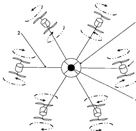
1. 共轴反转双转子十二旋翼飞行器,其特征在于,该飞行器包括机体(1)、六根支撑臂(2)、六个双转子(3)和电控系统(4),六根支撑臂(2)连接在机体(1)的周边,六根支撑臂(2)的几何中心线在同一平面上,相邻的两根支撑臂(2)的几何中心线夹角为60度;六个双转子(3)分别设置在六根支撑臂(2)的端部,电控系统(4)设置在机体(1)内,控制并连接六个双转子(3)。
