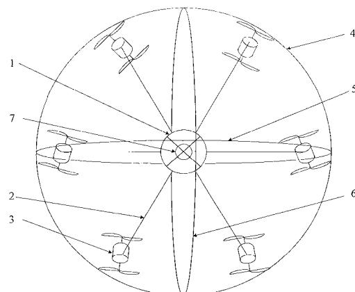
1. 具有滚动功能的十二转子飞行器，其特征在于，该飞行器包括机体（1）、六根支撑臂（2）、六个双转子（3）、第一支撑圆环（4）、第二支撑圆环（5）、第三支撑圆环（6）和电控系统（7），六根支撑臂（2）连接在机体（1）的周边，六根支撑臂（2）的几何中心线在同一平面上，相邻的两根支撑臂（2）的几何中心线夹角为 60 度，每根支撑臂（2）的一端固连在机体（1）上，另一端固连在第一支撑圆环（4）上；六个双转子（3）沿机体（1）的几何中心等臂距的分别设置在六根支撑臂（2）上；第一支撑圆环（4）、第二支撑圆环（5）、第三支撑圆环（6）的环径相等，其几何中心面互为正交，三个支撑圆环连接为一体，第一支撑圆环（4）、第二支撑圆环（5）、第三支撑圆环（6）的几何中心与机体（1）的几何中心相重合；电控系统（7）设置在机体（1）内，控制并连接六个双转子（3）。
