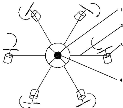
1. 一种六转子飞行器,其特征在于包括机体(1)、连接在机体(1)周围上的六根支撑臂(2)、分别设置在各支撑臂(2)端部上的六个转子(3)和设置在机体(1)中的控制连接各转子的电控系统(4),所述的六根支撑臂(2)的几何中心线在同一平面上、各相邻的两根支撑臂(2)的几何中心线夹角为60度。
