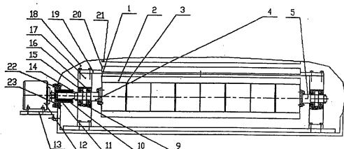
1、真空光学谐振腔中磁耦合空心轴组合式横流风机，其特征在于采用真空光学谐振腔中磁耦合，叶轮与隔板、叶片镶嵌式组合空心轴横流风机，该真空光学谐振腔中磁耦合空心轴组合式横流风机包括叶轮（1）、叶片（2）、隔板（3）、长轴头（4）、短轴头（5）、连接键（6）、螺钉（7）、锥销（8）、导套（9）、护套（10）、磁铁（11）、电机（12）、电机座（13）、锁紧螺母（14）、隔套（15）、轴承（16）、支板（17）、箱体（18）、电极座（19）、阴极（20）、阳极（21）、密封垫（22）、耦合器（23）；
