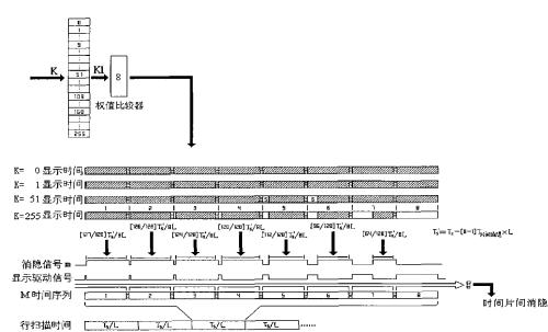
1、一种平板显示屏权值时间片间隔消隐扫描时间序列调制方法，利用权值时间片  $D[i]$  在单位时间内对显示屏进行多次反复扫描，从而形成有灰度级层次的视频图像；每个 LED 的导通时间采用加权求和的方法，对于任意一个 LED 像素的灰度值  $R[MSB:LSB]$ ，都有唯一的一个加权时间  $T_R[MSB:LSB]$  和与之相对
